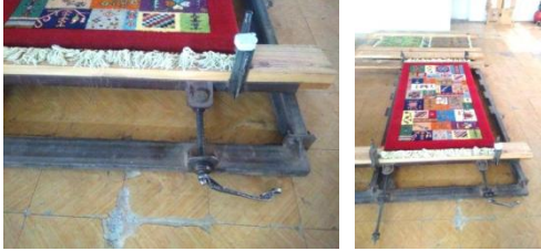
Fotoğraf 18: Biten halılarda ebada oturmayan ve çarpık çıkan halıların germe makinasında düzeltilmesi (Aral.2018).
