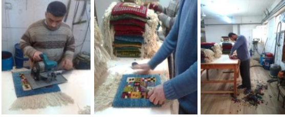
Fotoğraf 17: Ham Halının el makası ve traş makinasında ilme boylarının eşitlenmesi (Aral.2018).
