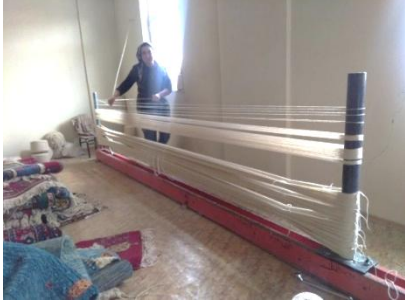
Fotoğraf 8: Yamancan'ın atölyesinde yeğeni tarafından "Çözgü çekme" işlemi (Aral.2018).
