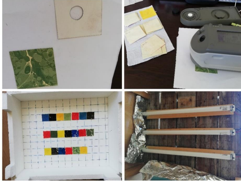
Görsel 3: Ebru örneklerinden ölçüm yapılacak alanın işaretlenmesi (sol üst), spektrofotometre ile ölçümlerin yapılması (sağ üst), numunelerin UV-yaşlandırma için yerleştirilmesi (sol alt), UV ampuller (sağ alt) (Kaynak: Güven ve Yetiş arşivi, 2022).
