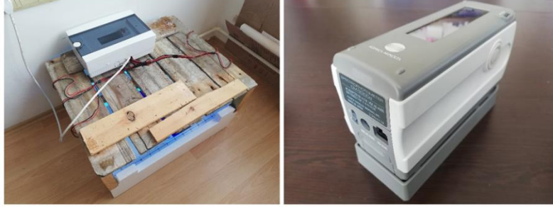
Görsel 2: UV (morötesi) yaşlandırma cihazı (solda) ve Konica Minolta marka spektrofotometre (sağda) (Kaynak: Güven ve Yetiş arşivi)
