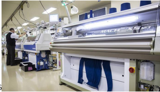
Görsel 6. Shima Seiki düz örme makinelerinde, dikişsiz olarak tek iplikle üretilen kazak. Financial Times, Haber: Leo Lewis https://www.ft.com/content/8d03bfae-4a3a-11e9-bde6-79eaea5acb64 20.01.2020
